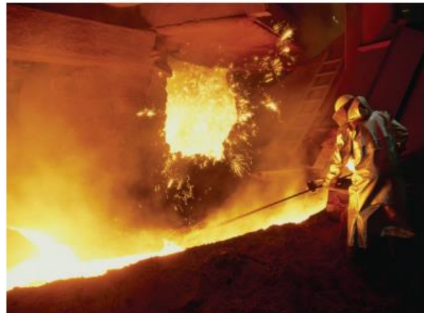
الصورة ٢-٤ أحد العاملين يرتدي ملابس واقية ويأخذ عينة من فرن الصهر في مصنع للصلب
