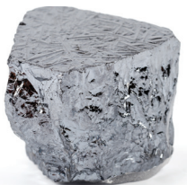
الصورة ٣-٢ عينة لعنصر السيليكون، الذي يعدّ المادّة الأساسية لصناعة أشباه الموصّلات
